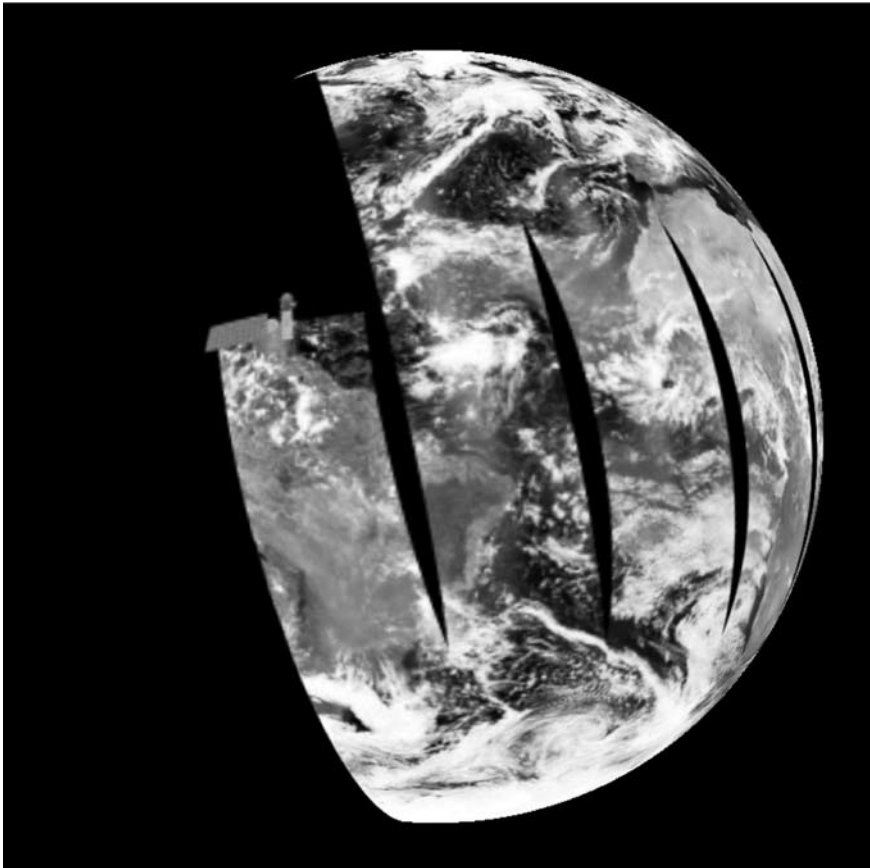
FIGURA 1. SISTEMA DE ESCANEEO DEL SENSOR MODIS (IMAGEN TOMADA DE HTTP://SOS.NOAA.GOV/IMAGES/ATMOSPHERE/AQUA_SWATH.JPG )
